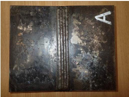
一般構造用圧延鋼材 SS400
