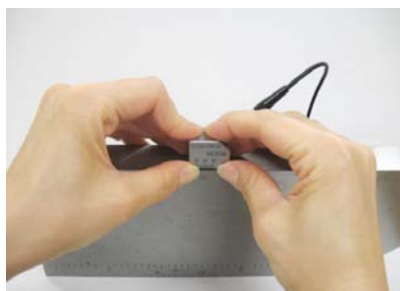
図2 屈折角測定の正しい探触子の保持方法
