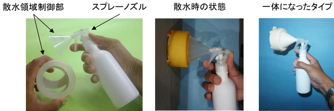
図1－散水試験装置（例）
