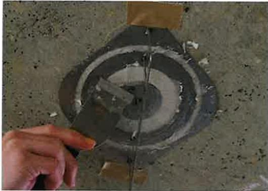
117 (a)コンクリートシール用型枠及びへらによる
