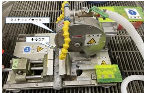
解説図 5—コンクリートカッターの例
