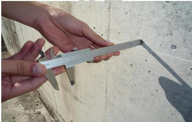
解説図 7—削孔深さの測定状況
