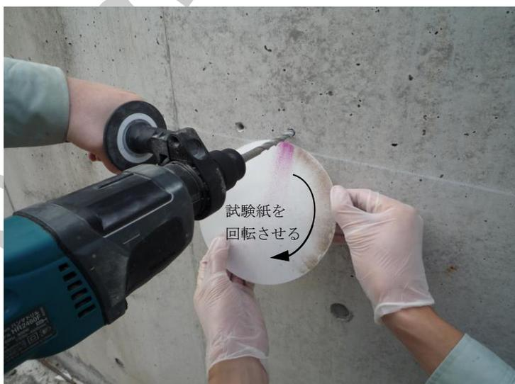
**解説図 5—ドリルによる削孔と試験紙の動かし方**
